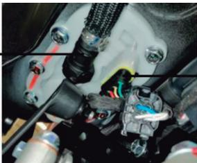
Retire el tubo de gasolina (con presión) de la bomba (9) y el conector de la bomba de gasolina (10).
