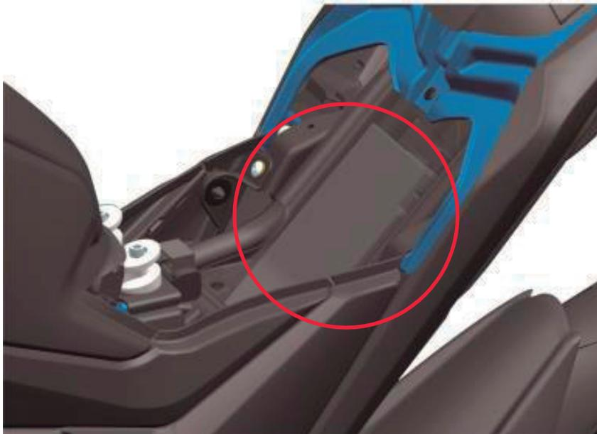
La batería se encuentra debajo del asiento del piloto. Se trata de una batería sin mantenimiento. Para su primer uso, conecte los bornes positivo y negativo y monte el tirante de goma.
