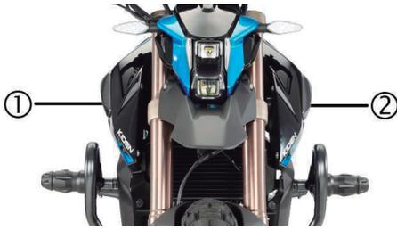
Desmonte las pestañas de fijación, (1) y (2), entre la cubierta exterior del depósito y los aletines laterales del carenado.
