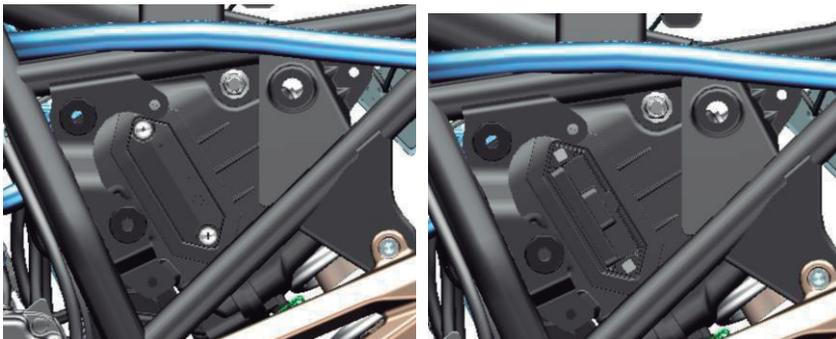
El filtro del aire se encuentra bajo el asiento. Si el filtro del aire está sucio, puede hacer que se obstruya el paso del aire de admisión, baje la potencia y aumente el consumo de combustible. Si conduce en zonas polvorientas, deberá aumentar la frecuencia de limpieza del filtro del aire o su cambio. Complete los siguientes pasos para realizar la limpieza del filtro del aire.
