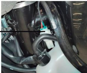
Retire el conector del cable de apertura de la tapa del depósito de gasolina (8).
